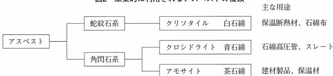
図2 工業的に利用されるアスベストの種類
