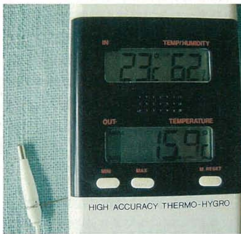
写真2 延長センサ(左端)を備えたサーミスタ温湿度計23°Cと62%は室内の温湿度を示し、下段の15.9°Cは延長センサの温度を示す。
