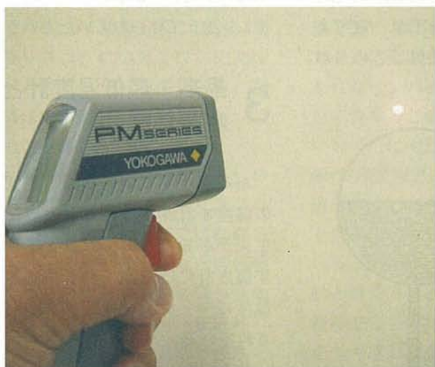
写真3 ポータブル赤外線放射温度計レーザーポインタの照準点の温度を非接触にて計測が出来る。
