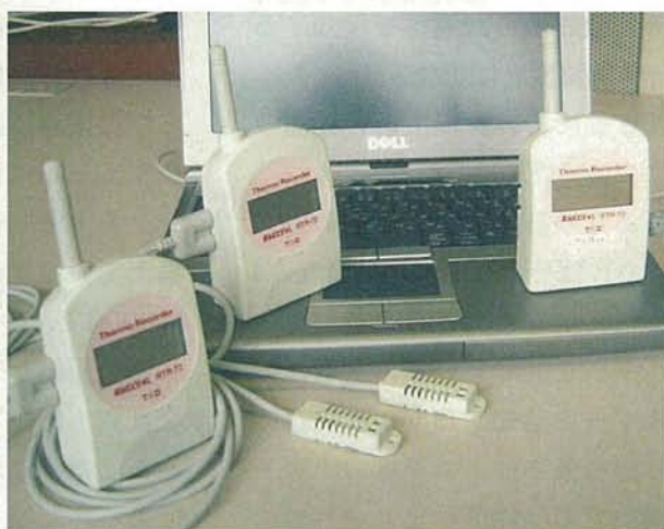
写真6 ワイヤレス温湿度データロガーの構成 左側の2台の子機で計測したデータを無線にて親機に伝送する。一台の親機は最大126台の子機からの信号を処理できる。
