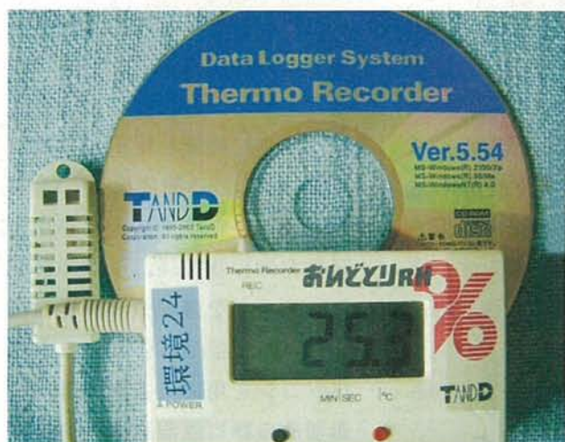
写真5 サーマレコーダ「おんどとり」 微小な温度センサと湿度センサが左側のケーシングに組み込まれている。
